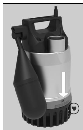
Těleso čerpadla je automaticky odvzdušněno. Pokud to není žádoucí, může být ventilační otvor uzavřen, např. pro mobilní provoz.
