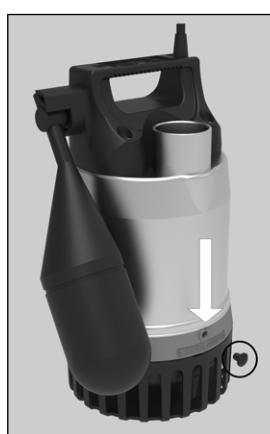
Das Pumpengehäuse wird automatisch entlüftet. Wenn dies nicht gewünscht ist, kann die Lüftungsöffnung geschlossen werden, z.B. für den mobilen Betrieb.
